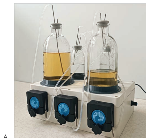
Рисунок 2. Дистанционно управляемая программируемая динамическая проточная система, моделирующая режимы энтерального введения антимикробных лекарственных средств в режиме селективной деконтаминации кишечника
