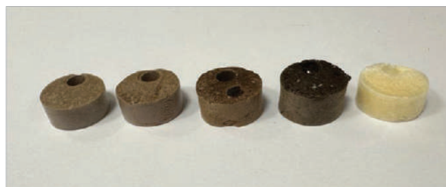
Рисунок 1. Внешний вид заготовок оболочки объемных пористых композиционных каркасов с включенными в структуру антимикробактериальными веществами
