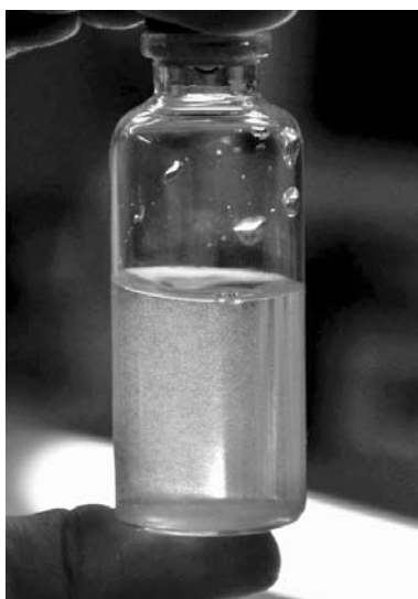
Рис. 3. Фотография флакона №13 партии № 8D25E «Меропенем Спенсер» (Cooper Pharma Ltd.): видимые частицы нерастворенного вещества через 4 ч после разведения.
